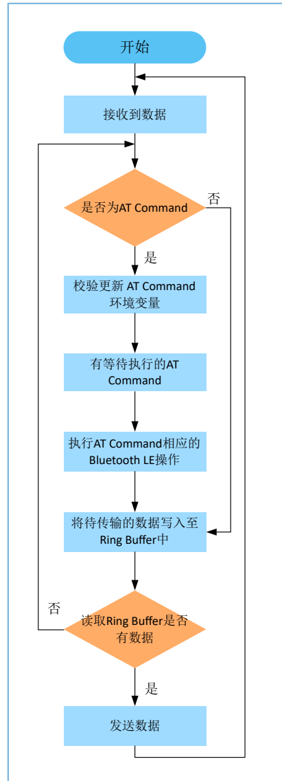
图 4-1 ble_app_uart_at示例运行流程
